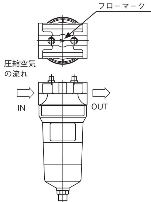
8. 右側が空気入口になるなど配管の都合上、フィルタが背を向けてしまう場合は、付属のシールを正面同様に貼り付けてください。
